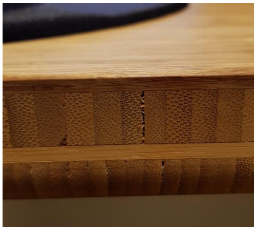
Figure 1 åpning mellom spileseksjoner
